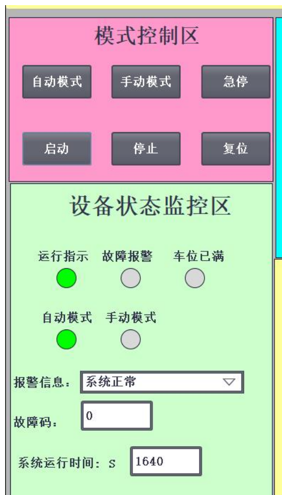
图 5-5 启停与模式切换测试画面
