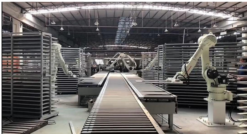
图 1-1 自动化物料分拣生产线现场图
