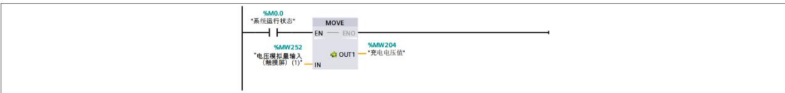
网络 11：模拟量值存储 - 存储到 MW 用于比较（温度）
