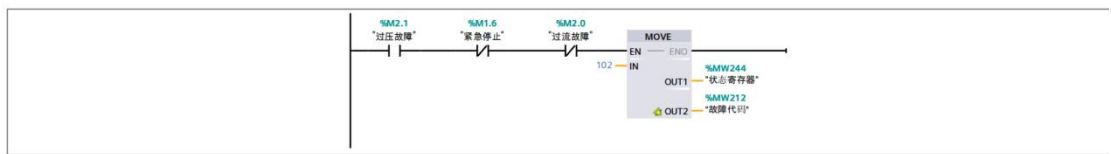
网络 59：状态寄存器更新 - 103 漏电故障状态
