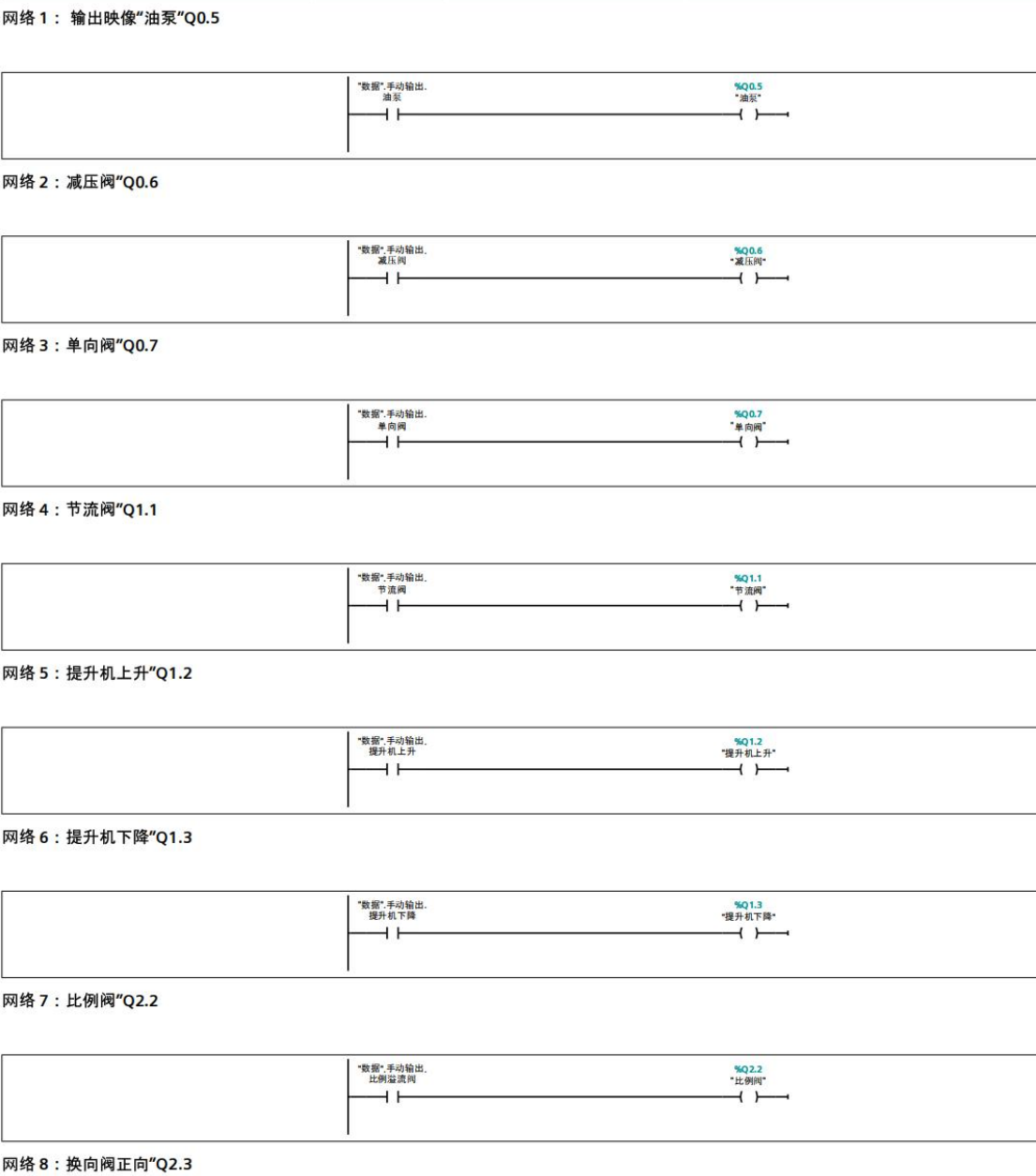
图 5-4 制动联锁真值表与对应梯形图
