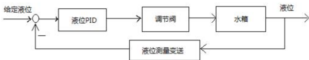
图 2-3 恒液位闭环控制一般结构检测
